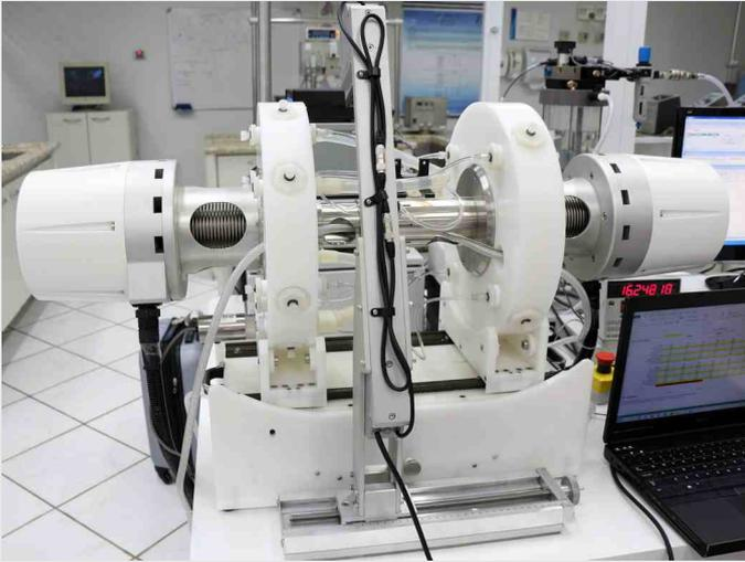
O Laboratório de Testes e Ensaios, da Braile Biomédica, possui um novo equipamento. Trata-se da *EletroForce Bose Stent/Graft Test System*, fabricada pela Bose Corporation, dos Estados Unidos.
